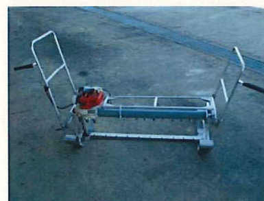
法面作業道を利用した草刈機による草刈り
