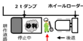
スコップで砂利敷き作業中に挟まれた
