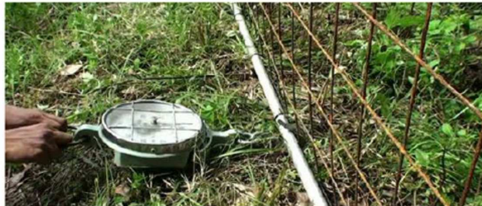
接地部の補強により70kg重の力量を加えても破壊されない (反対向きに力量を加えても同様)
